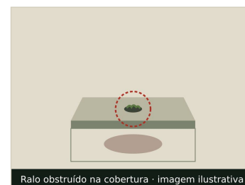
Ralo obstruído na cobertura · imagem ilustrativa NC-01 · 16/10/2026, 14:23 · -23.49720, -47.44610 ±6 m
